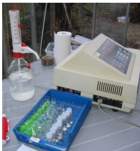
Foto 2. Prøverne med sporstof står klar til analyse i fluorimeteret. Derved kan den præcise mængde sporstof måles.
