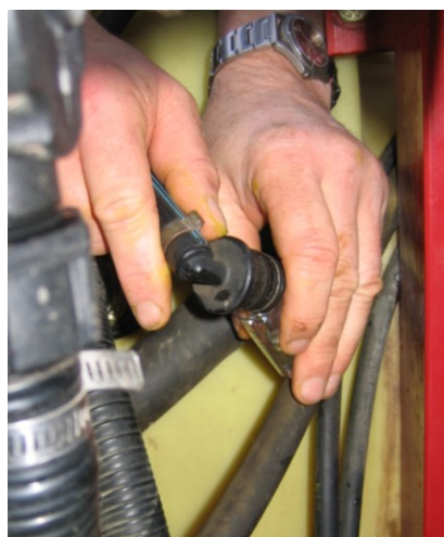
Foto 3. Her tages en prøve af slangen til en af ligetryksventilerne.
